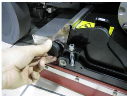
1) Открутить винт бокового сквиджа
