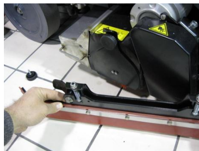
2) Снять боковой сквидж
