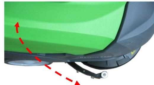
Широкий диапазон перемещения балки и колесо-отбойник для защиты от повреждений..
