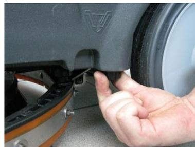
Пробка для слива в задней части машины
