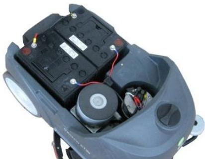
Большой аккумуляторный отсек позволяет установить батареи емкостью 74 Ач (Время работы – 2 часа)
