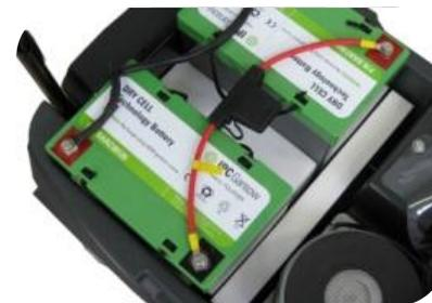
Версия Eco укомплектована двумя аккумуляторами емкостью 45Ач (Время работы 1.30 ч)
